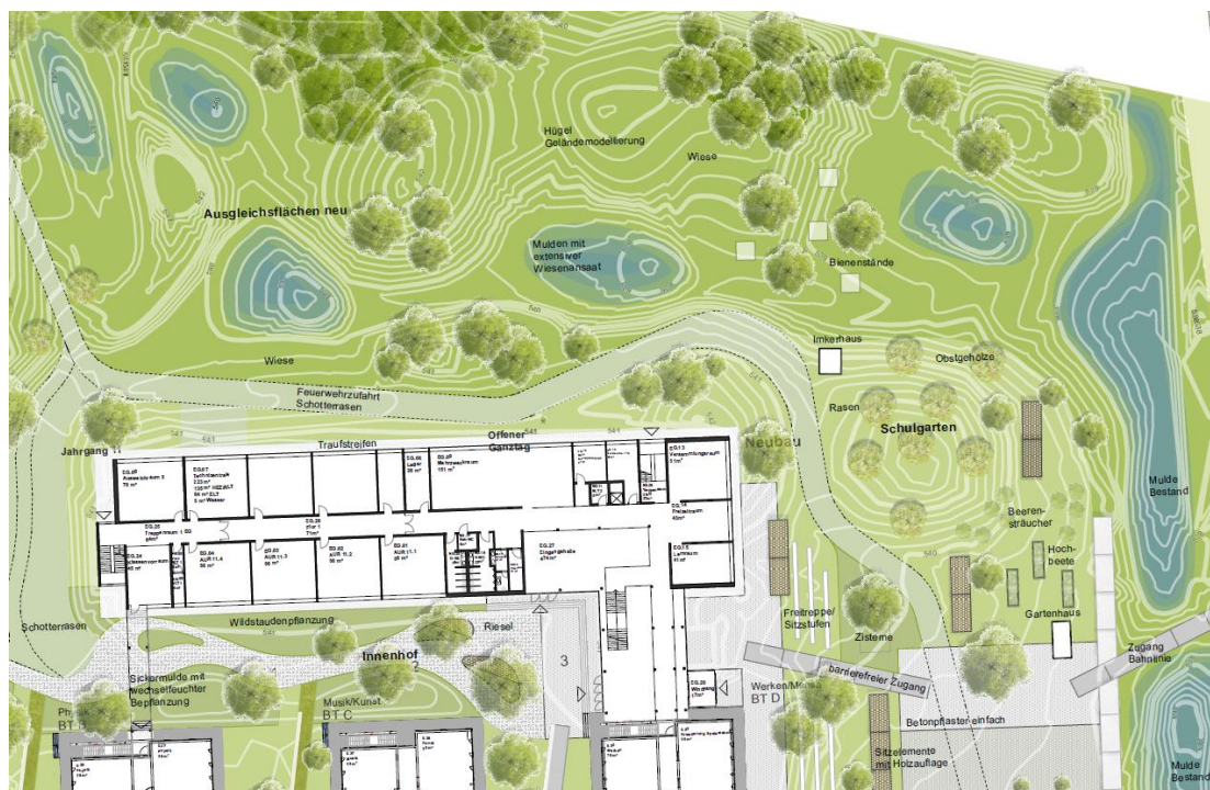
Abb. 11 Entwässerungskonzept (BEM Landschaftsarchitekten, 19.05.2022)
